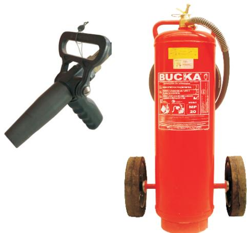
Extintor de incêndio sobre rodas, com carga de pó químico seco à base de fosfato monoamônico (Totalit Super ABC), fabricado de acordo com a norma NBR 15809. Fabricado em chapa de aço carbono com pressurização direta com nitrogênio (N<sub>2</sub>).
