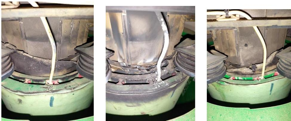
Fotos 2, 3 e 4: Enrolamentos 1, 2 e 3 do transformador 750 kVA, avariados.
